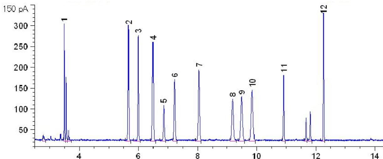
出峰顺序：1-丙溴磷；2-甲拌磷；3-乐果；4-二嗪农；5-乙拌磷；6-异稻瘟净；7-甲基对硫磷；8-马拉硫磷；9-毒死蜱；10-对硫磷；11-稻丰散；12-乙硫磷。
