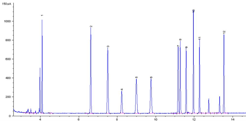
出峰顺序：1-丙溴磷；2-甲拌磷；3-二嗪农；4-乙拌磷；5-异稻瘟净；6-乐果；7-毒死蜱；8-甲基对硫磷；9-马拉硫磷；10-对硫磷；11-稻丰散；12-乙硫磷。
